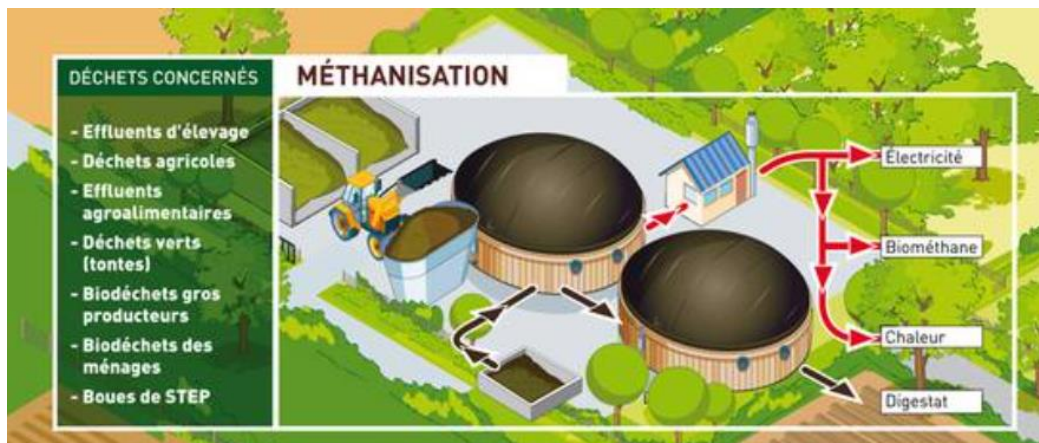
Principe de Méthanisation Source : ADEME
